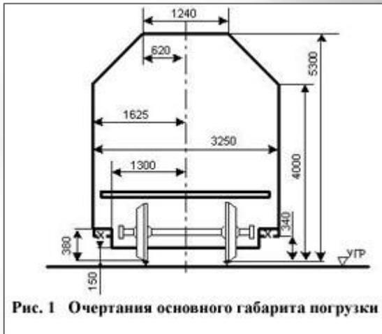
Рис. 1 Очертания основного габарита погрузки
